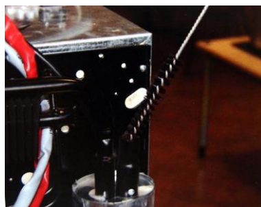
Pročištění celého komínku
