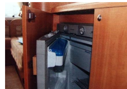
Obrázek 6 vestavěné chladničky často nemají aretaci mikro ventilace
