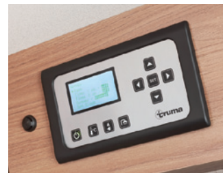
■ K ovládání systémů karavanu slouží přehledný panel.
