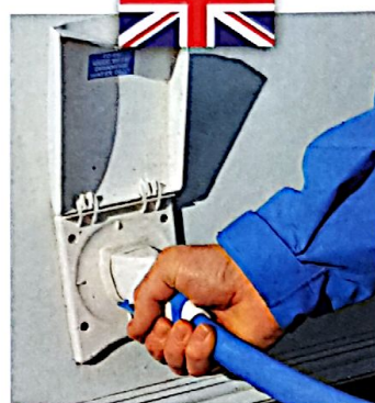
■ Nádrž na vodu je umístěna vpředu a plní se venkovním čerpadlem Truma.
