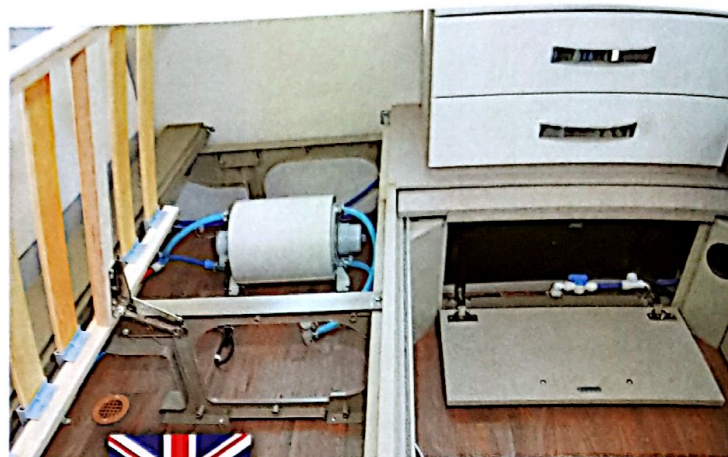
■ Nádrž na vodu je umístěna vpředu a plní se venkovním čerpadlem Truma.
